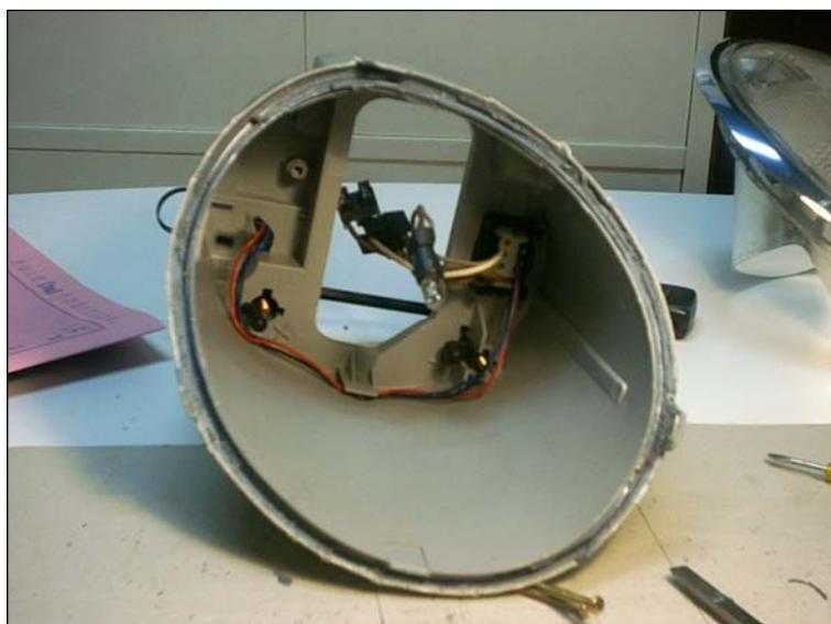
semplice nemmeno togliere le impronte digitali. Per estrarre il motorino staccare lo spinotto tirandolo in avanti e svitare le due viti con un cacciavite a croce. Ora potete sostituire il motorino o provare a ripararlo come riportato nel paragrafo successivo e rimontare il tutto.
