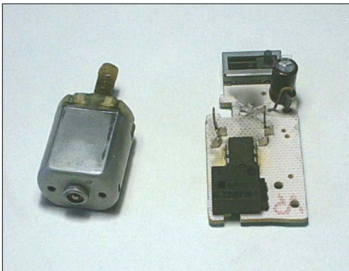
verificato le spazzole estraendole dalla parte in plastica della carcassa de motore e ho trovato il difetto. In pratica una parte, forma di "U", della spazzola si era staccata ad una estremità e faceva contatto con la spazzola del polo opposto. Rimontato il tutto e oleato per bene ho riassemblato il motorino e ne ho verificato il funzionamento. Non dimenticate di collegare alla parte meccanica il rilevatore di posizione che si trova sulla scheda, basta un clic.
